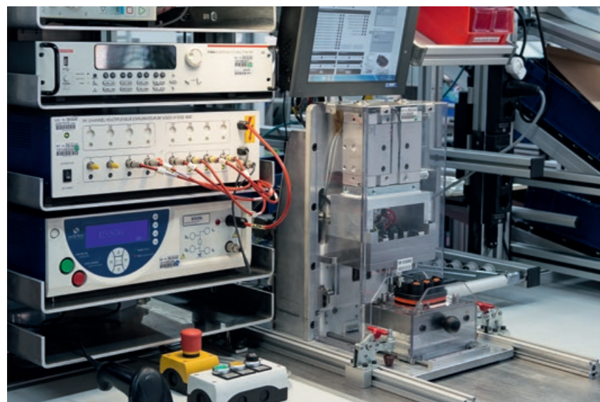
Vollautomatische Hochspannungsprüfung in Serie – für uns ein Qualitätsstandard.
