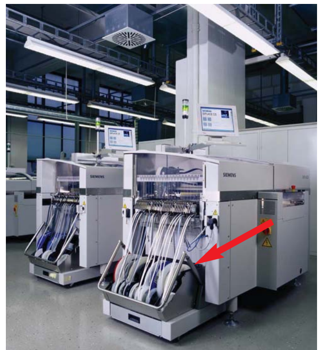
■ Bild 4: Pick & Place-Automat: Das Zuführmodul wird über ODU MAC angedockt
