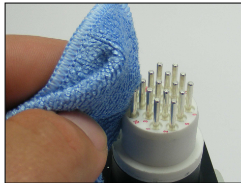
Abb.II – Reinigung mit sauberem, fuselfreiem Tuch
