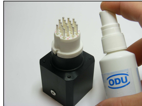
Abb.IVa – Schmiermittelauftrag mit Sprühflasche
