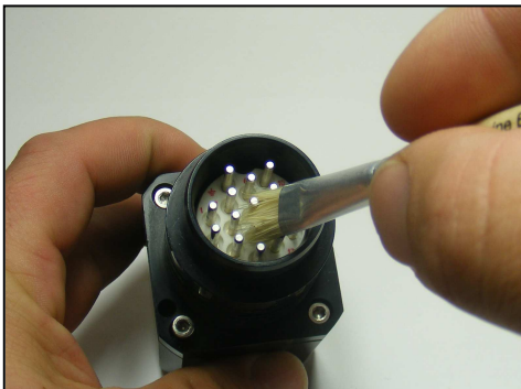
Abb.III – Reinigung mit Reinigungspinsel
